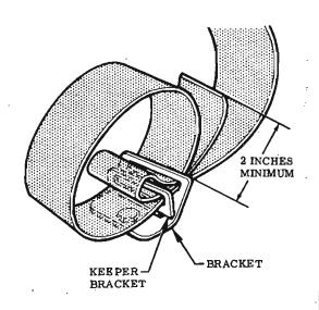
FIG. 11 OPERATION PROCEDURE & BELT ADJUSTMENT
