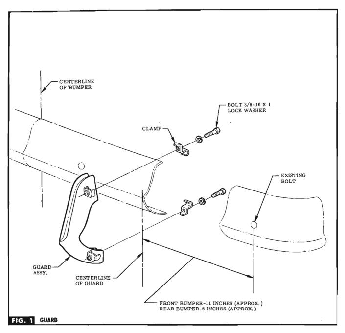
**STEP 1** INSTALL GUARD ON FRONT OR REAR BUMPER AT LOCATION SHOWN WITH ATTACHING PARTS PROVIDED. UPPER & LOWER BOLTS SHOULD BE TIGHTENED PROGRESSIVELY TO INSURE PROPER FIT. SEE FIG. 1.
